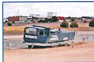
Ensayo TB 42 Camión de 10.000 Kg., a 70 Km/h y 15°
